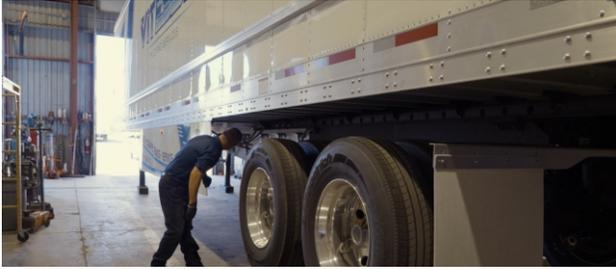
Après le traitement, faites l'inspection de la remorque, vérifier les fuites (mousse blanche), fermer la valve d'admission d'air, vidanger les réservoirs.
